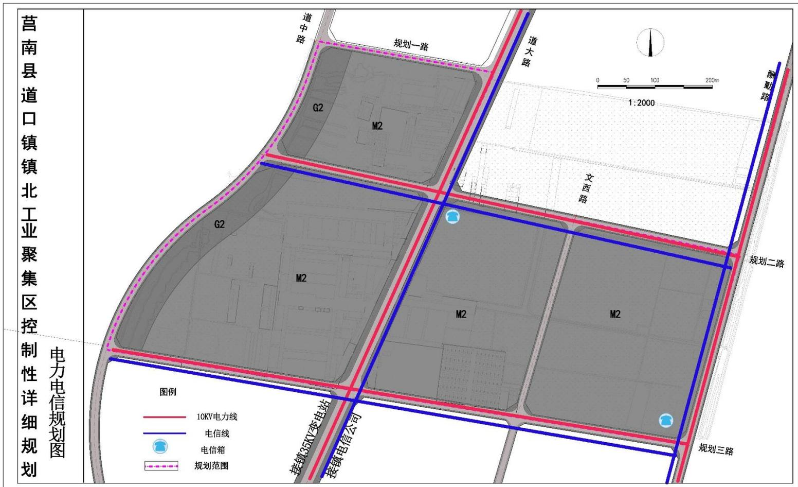
图 3.5-2 聚集区电力电信工程管线规划图
